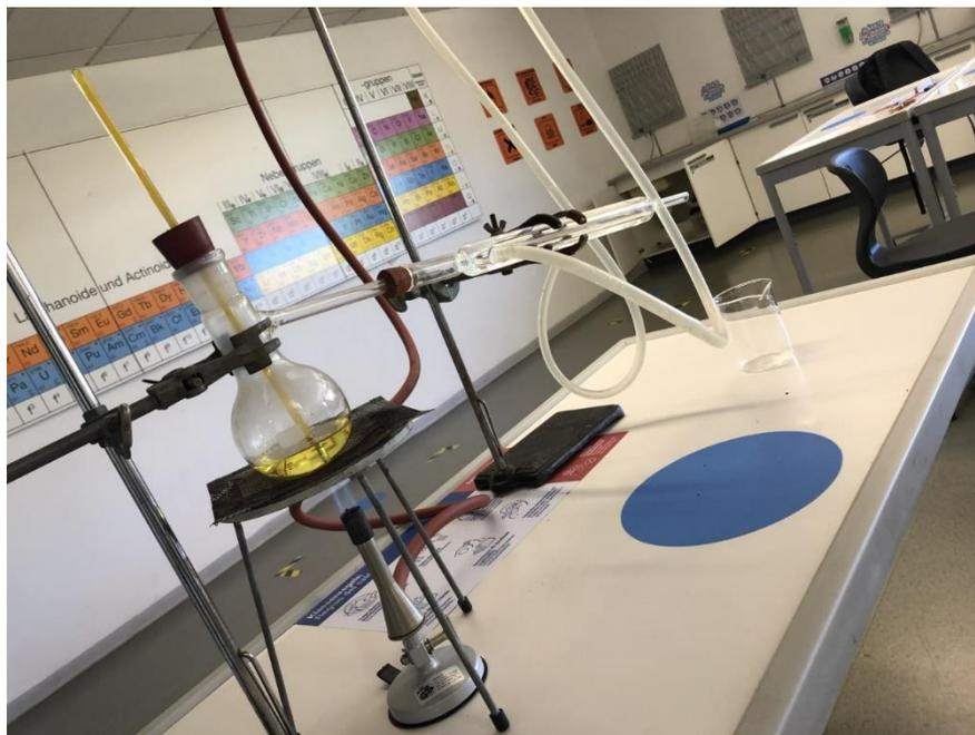
**Figura 7.** Calentamiento y mezcla durante la síntesis de N-fenilhidroxilamina
