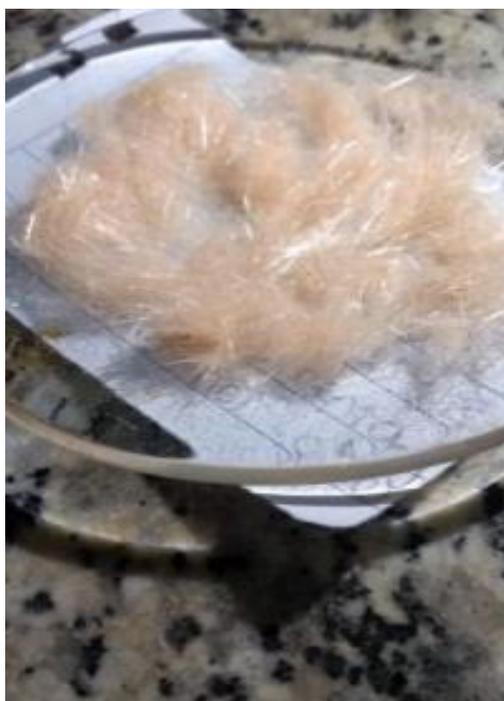
**Figura 10.** Muestras de *N*-Fenilhidroxilamina recristalizadas obtenidas con las diferentes metodologías.
